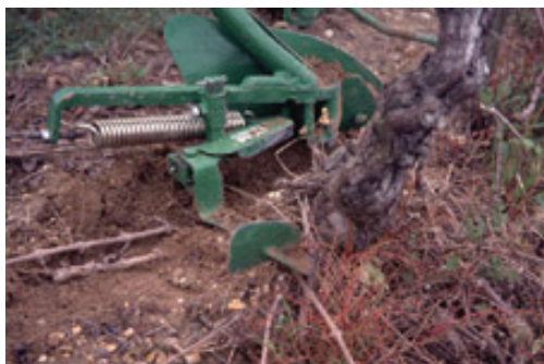
photo 6 : cure-cep monté derrière Décalex Souslikoff
