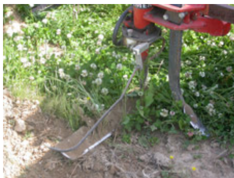
photo 2 : lame intercep Clemens, système d'effacement hydraulique
