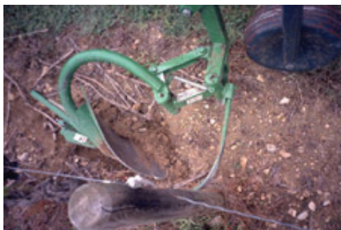
photo 1 : Système d'effacement mécanique sur Décalex Souslikoff
