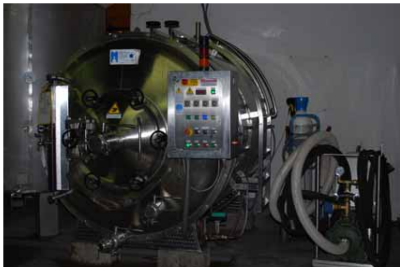
Photo 2 : Vinificateur Gioiello – en macération, avec macro-oxygénation
