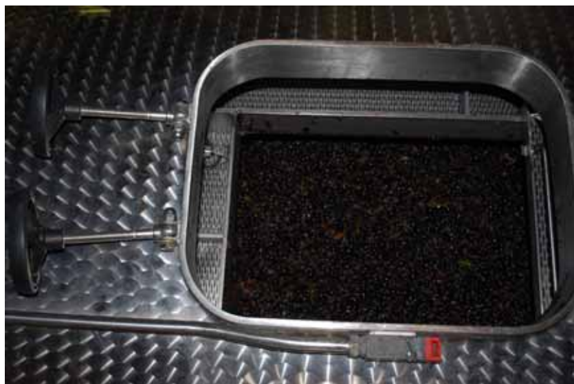
Photo 3 : Vinificateur Gioiello – tambour intérieur à cage ajourée
