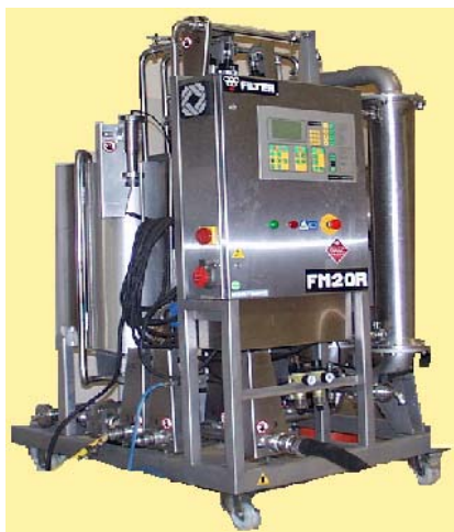
Photo1 : Filtration Tangentielle Vaslin Bücher FM 20 R ITV France Bordeaux Blanquefort 2002
