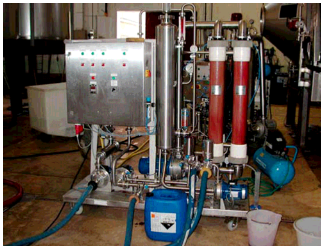
Photo2 : Filtration Tangentielle Pall Oenoflow ITV France Nimes 2003
