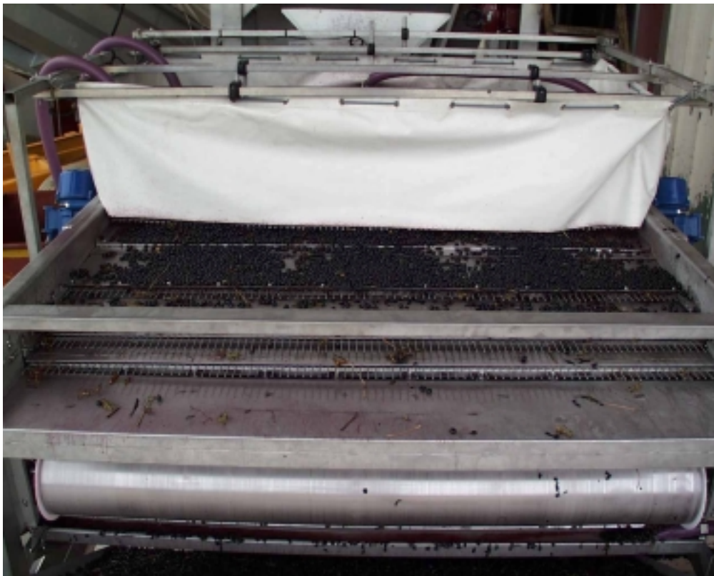
Photo 2 : Séparateur vibrant – Matévi 2001
