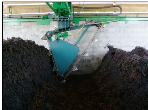
Photo : VIGNALEX® Système automatisé de retournement et d'arrosage du compost © KADIRI - Souslikoff
