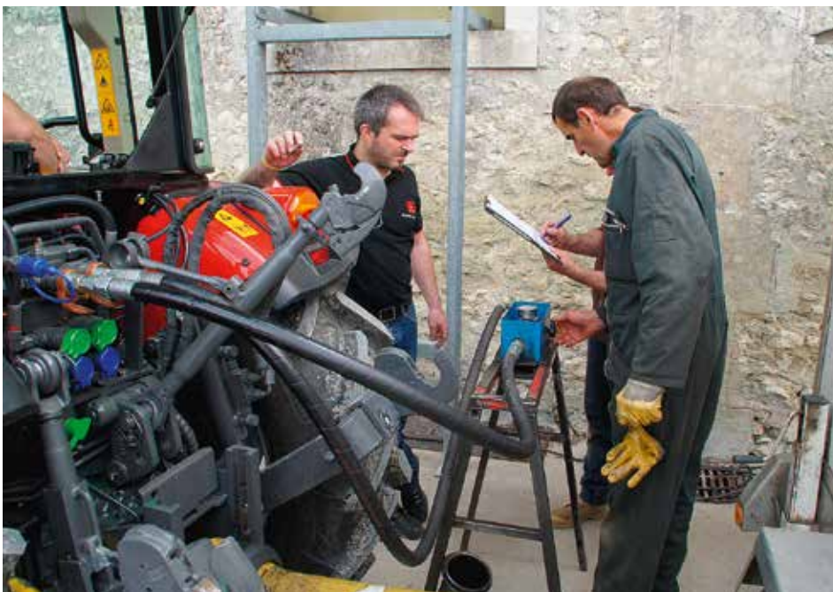
Les mesures de débits des circuits hydrauliques.
