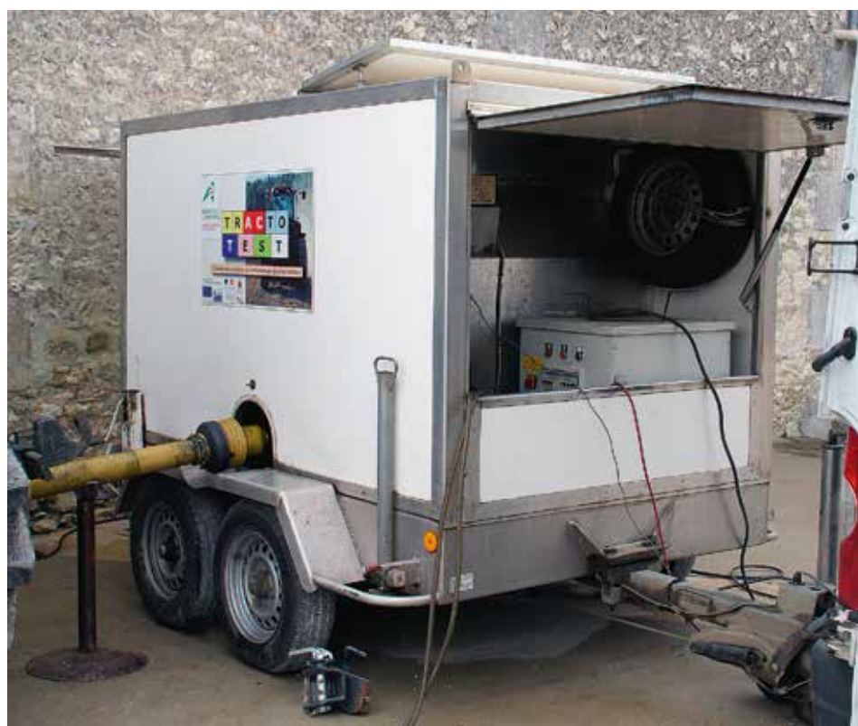
Le banc d'essai des moteurs.
