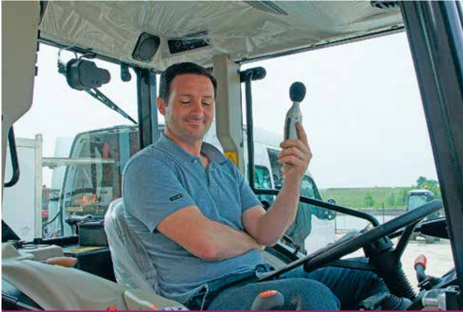
Les mesures de niveau sonore à l'intérieur de la cabine.
