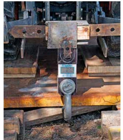
Le dynamomètre qui a enregistré les forces d'effort des relevages.
