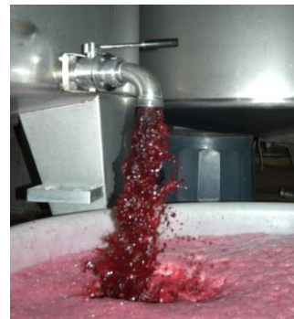
Remontage avec aération – IFV 2008
