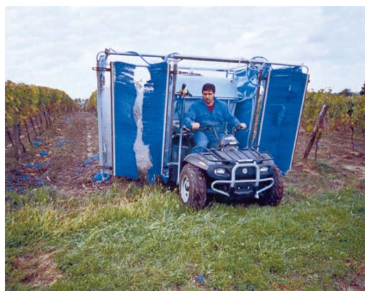
Pulvérisation S21 panneaux récupérateurs sur quad
