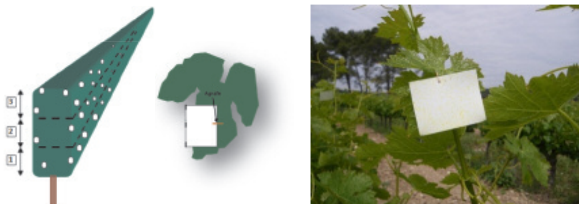
Figure 1 : Collecteur plastique disposé dans la vigne en vue d'évaluer la qualité de la pulvérisation.
