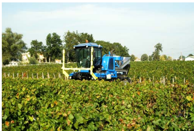
Photo 1 : Machine à vendanger VN 260 New Holland pour vignes étroites
