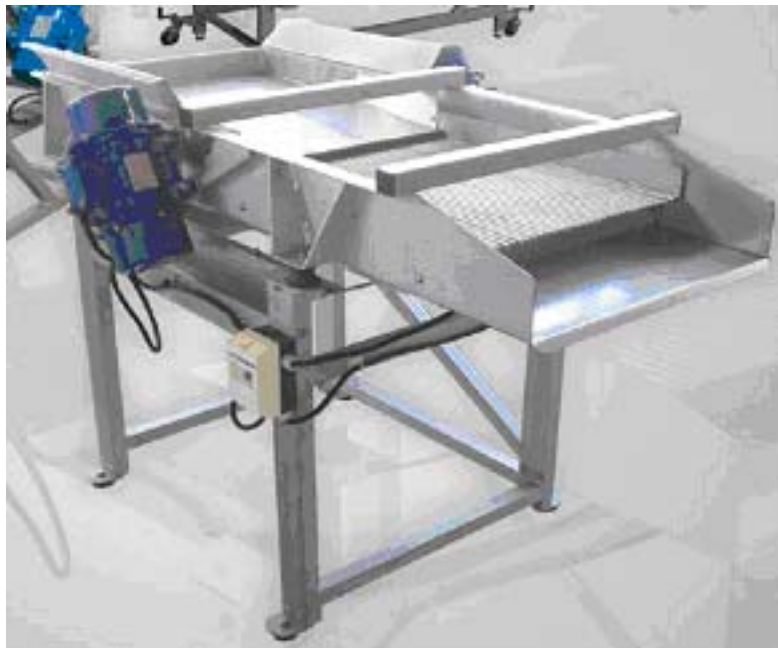
Photo 5 : Table de tri vibrante avec grille de tamisage (MATEVI)
