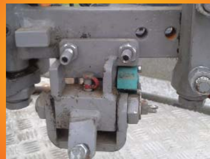
1 Le capteur assure le recentrage et le contrôle de profondeur.
