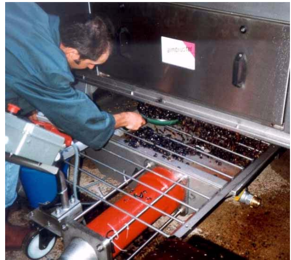
Photo 2 : Prélèvement de la vendange à la sortie de l'érafloir
