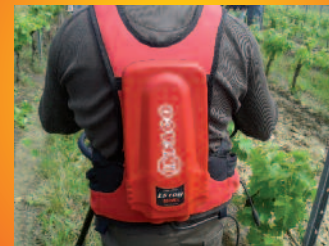
2 Nouvelle batterie Li-Ion de 500 Wh. Elle assure une autonomie de 8 heures de travail.
