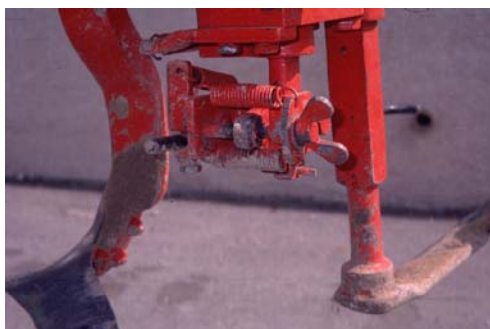
photo 4 : exemple de réglage pour la sensibilité du pare-cep
