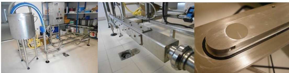
Photo 1 : Manchon équipé des coupons extractibles (inox) incorporé au circuit-test (P. Poupault. IFV)
