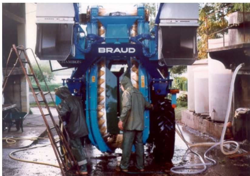
photo 2 : Prélavage à eau perdue (ITV France Bordeaux-Blanquefort 2000)
