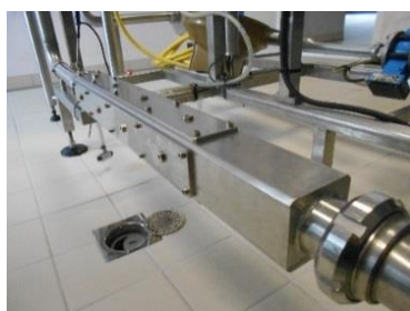
Photo 3 : Manchon équipé des coupons extractibles (inox) incorporé au circuit-test (IFV)
