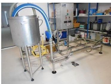
Photo 3 : Manchon équipé des coupons extractibles (inox) incorporé au circuit-test (IFV)
