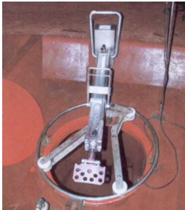
Photo 4 : Pigneur mobile Seguin-Moreau (source ITV Bordeaux-Blanquefort 2002)
