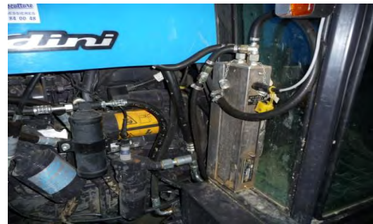
Photo 4 : Débitmètre gasoil monté sur tracteur pour mesure consommation
