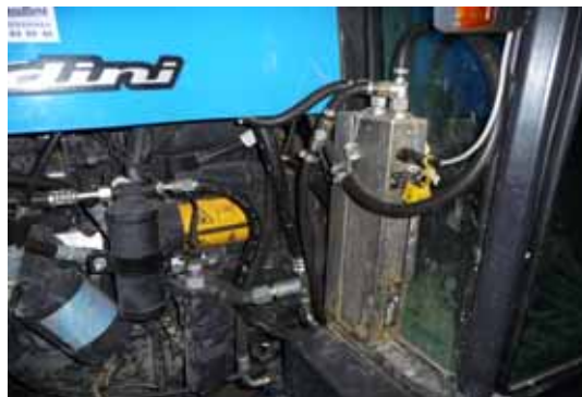
Photo 4 : Débitmètre gasoil monté sur tracteur pour mesure consommation
