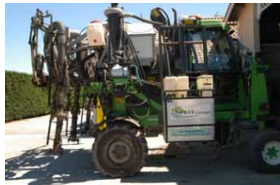
Photo 1 : Le système d'injection directe SPID2 Sté Spray Concept
