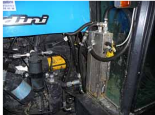
Photo 3 : Débitmètre gasoil monté sur tracteur pour mesure consommation
