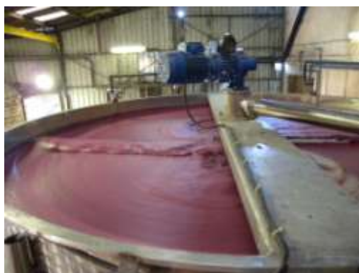
Photo 12 : Cellule de flottation en vinification en rouge
