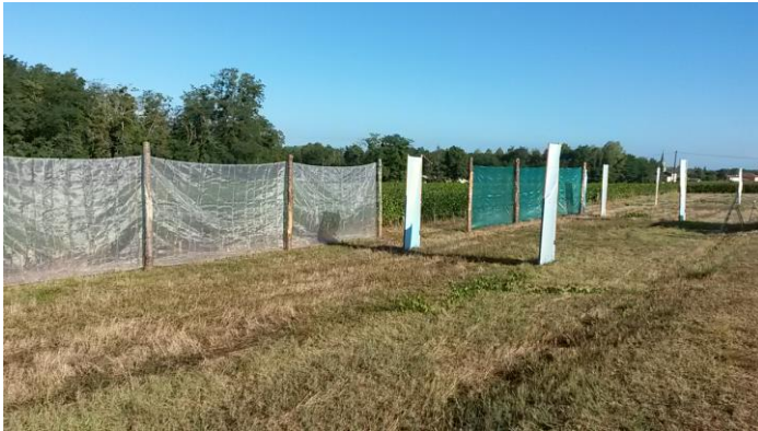
Photo 2. Filets positionnés à 1 et 3 mètres de la vigne et collecteurs
