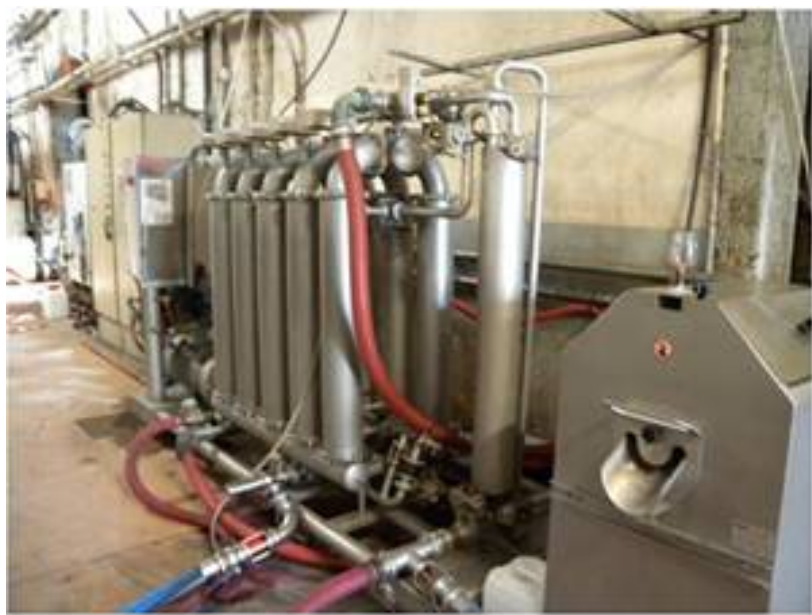
Photo 1 : Pré-filtre à tambour rotatif et filtre tangential de 60m 2 . J. M. Desseigne
