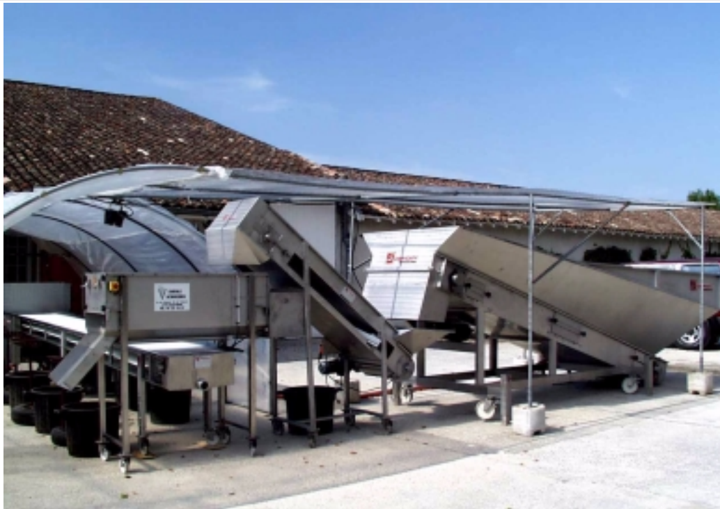
Photo 1 : Chaîne de réception - conquet - tapis - érafloir - table de tri
