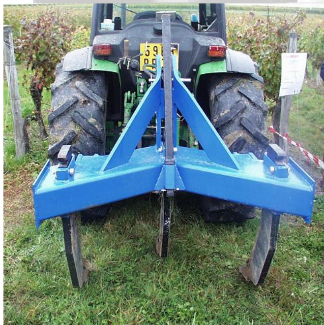
Exemple de sous-soleuse et ameublissement constaté après réalisation d'une fosse
