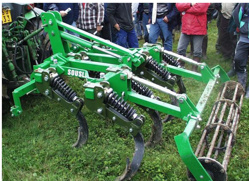
Exemple de décompacteur et ameublissement constaté après réalisation d'une fosse
