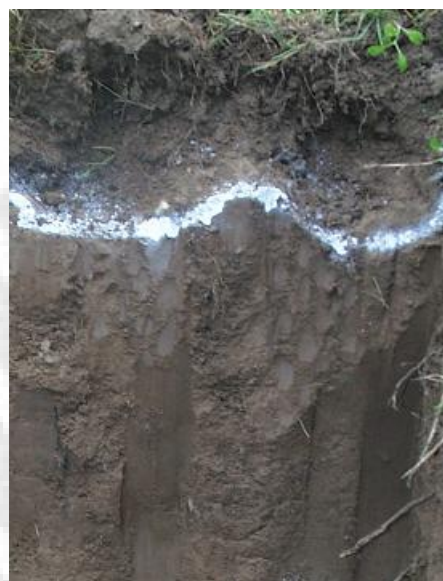
Exemple de décompacteur et ameublissement constaté après réalisation d'une fosse
