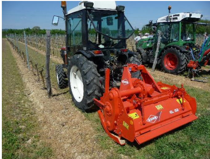
Photo 1 : Rotovator – IFV Pôle Sud-Ouest 2019 - C.Gaviglio
