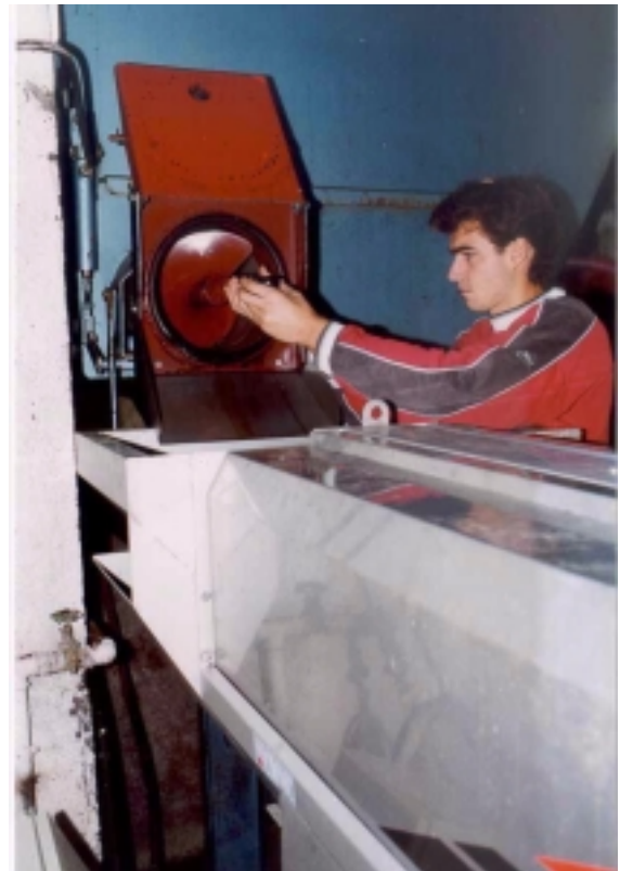
Photo 4 : Réglage de la vitesse d'alimentation par conquet à vis à l'aide d'un tachymètre
