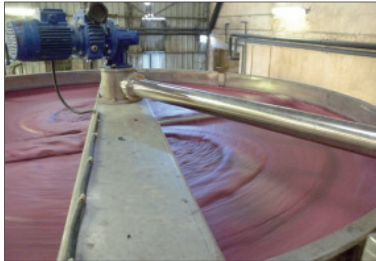
Elimination des bourbes en flottation continue.
