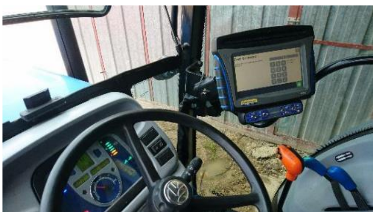
Console de la barre de guidage en cabine
