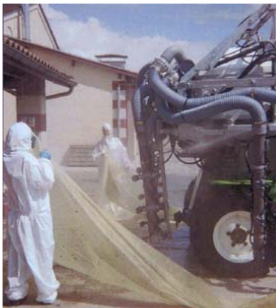
Test d'évaluation des volumes d'effluents de pulvérisation Photo : ITV Aquitaine-2003
