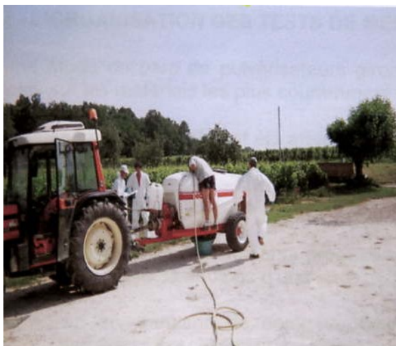
Rinçage intérieur de la cuve du pulvérisateur Photo : ITV Aquitaine-2003
