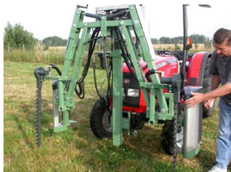
Effeuilleuse Magnosto : rouleaux et barre de coupe
