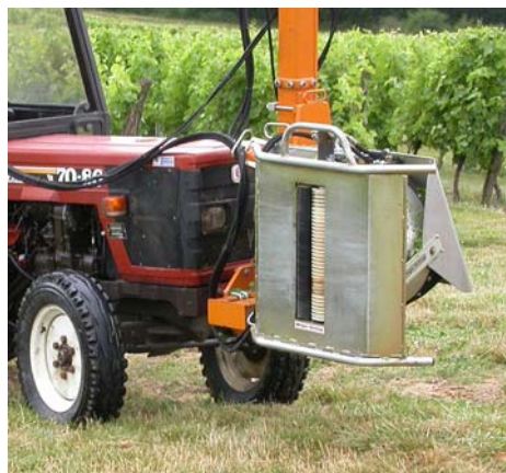
Effeuilleuse à rouleaux Binger Seilzug
