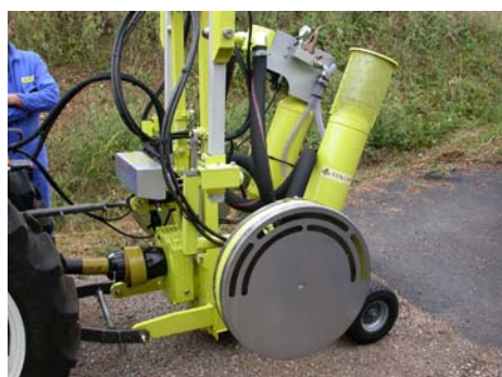
Effeuilleuse pneumatique Collard
