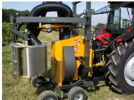
Turbine et tête d'effeuillage Grégoire
