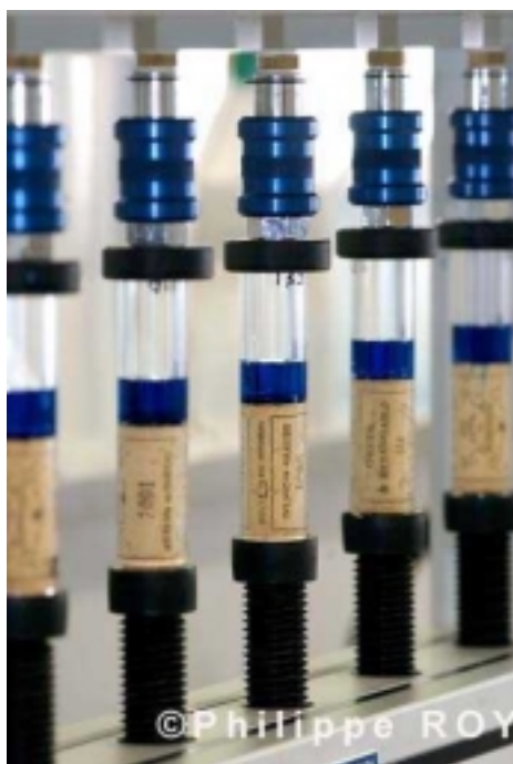
Cet appareil sert à mesurer les pressions d'étanchéité au liquide
