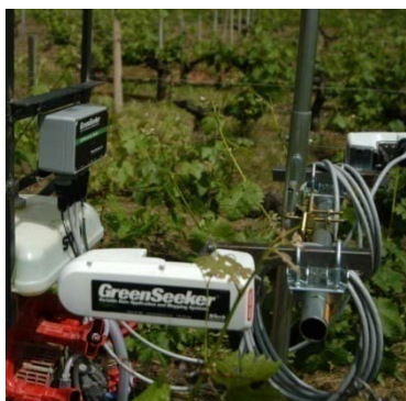
Figure 2 : montage de 2 cellules greenseeker RT 200 sur automoteur Solo
