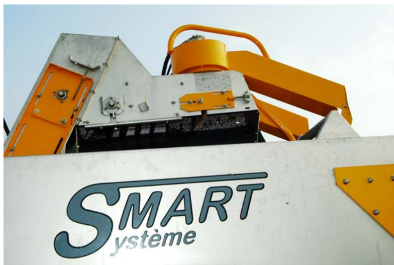
photo 4 : Trieur embarqué sur machine à vendanger Pellenc – ITV Bordeaux-Blanquefort 2004
