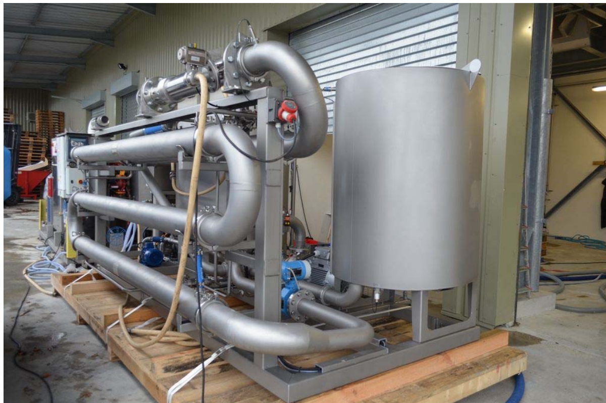
Photo 3 : filtre tangentiel à membrane en acier inoxydable. F. Davaux
