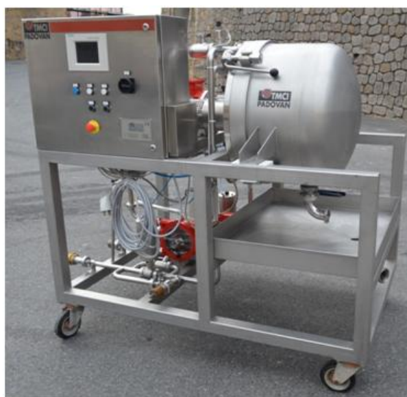
Photo 2 : filtre tangential à disques rotatifs. F.Davaux
