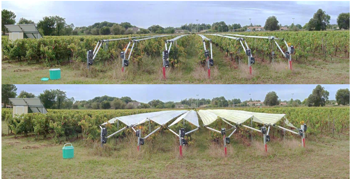
Figure 1 : dispositif Viti-Tunnel sur 6 rangs replié (haut) et déployé (bas) ©IFV
