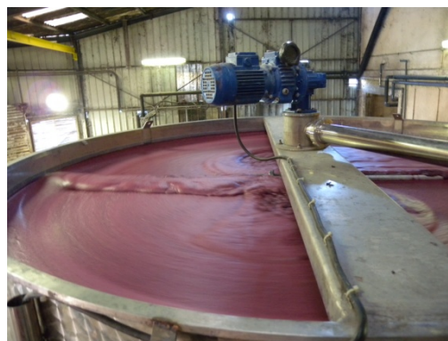
Photo 11 : Cellule de flottation en vinification en rouge
