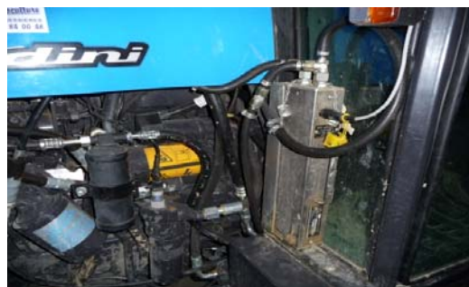
Photo 3 : Débitmètre gasoil monté sur tracteur pour mesure consommation
