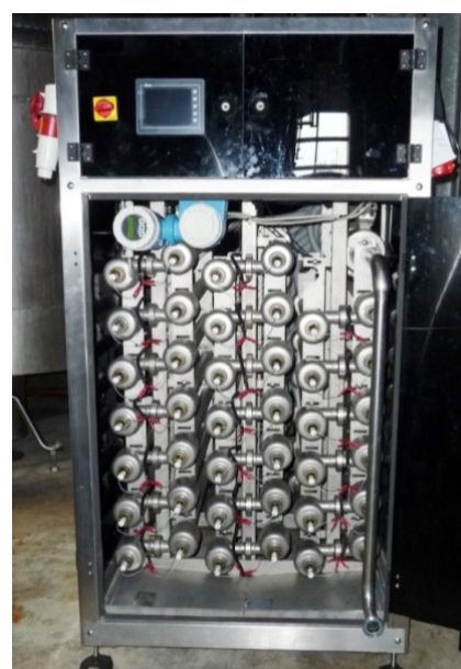
Photo 16 : Stabilisation à Froid par UV-C
