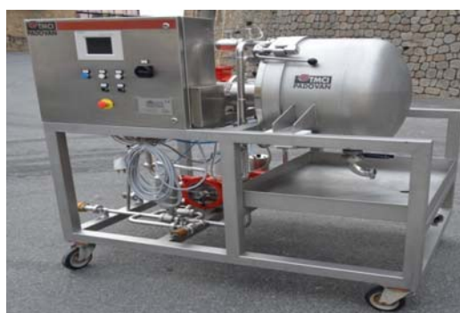
Photo n°14 Filtre tangentiel à disques rotatifs
