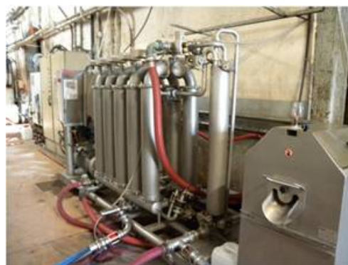
Photo n° 13 Pré-filtre à tambour rotatif et filtre tangentiel de 60m 2
