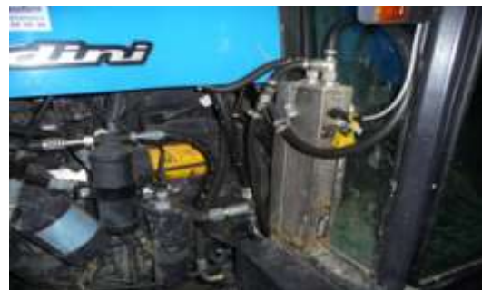
Photo 5 : Débitmètre gasoil monté sur tracteur pour mesure consommation
