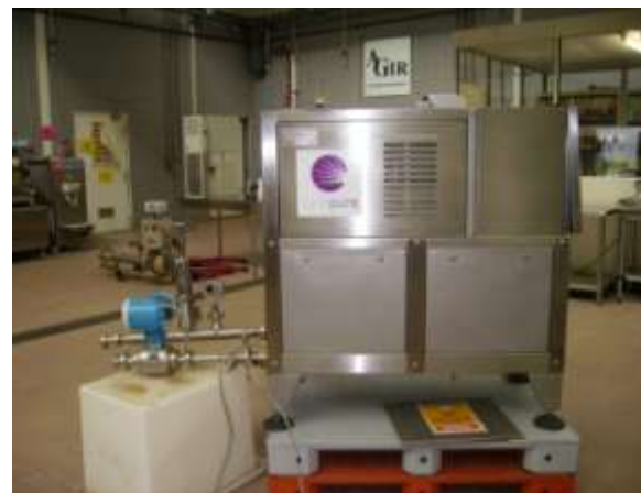
Photo 16: Appareil de traitement aux UV-C
