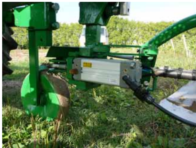
Vue du vérin pneumatique
