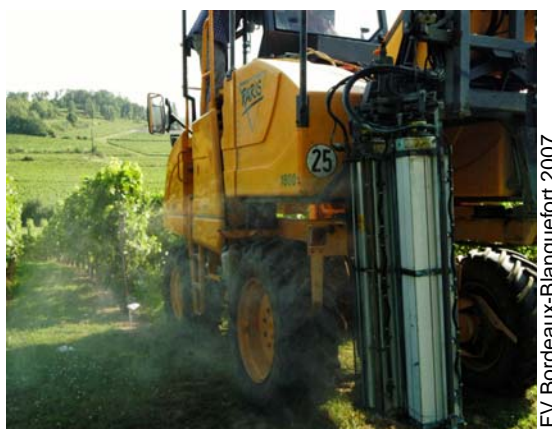
Photo 1 : Traitement avec un appareil à pression et à jet porté (Holder)
