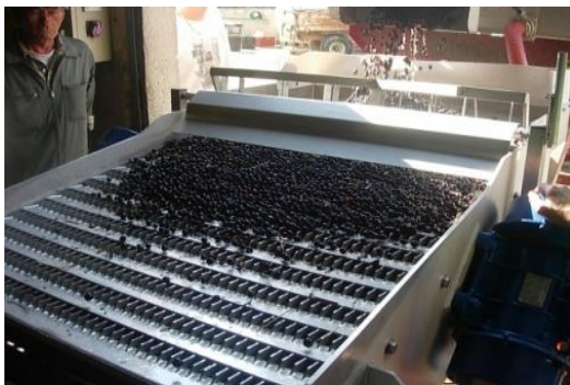
Photo1 : Table de tri vibrante (Sté MVS)
